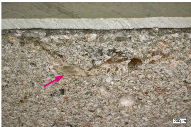
Abb. 2 a-b: Alkaliempfindliche Gesteinskörner, die Schäden in Form von Rissen aufwiesen, die sich in Richtung des Zementsteins fortsetzen
