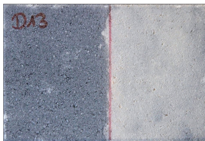
Bild 2: Aufhellung der mit Fugenmaterial beaufschlagten Pflastersteinoberfläche nach der Reinigung durch trockenes Abfegen mit einem Besen (rechte Bildhälfte).
