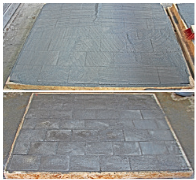
Abbildung 4: Oben: trockenes Einfegen, unten: nasses Einschlämmen.
