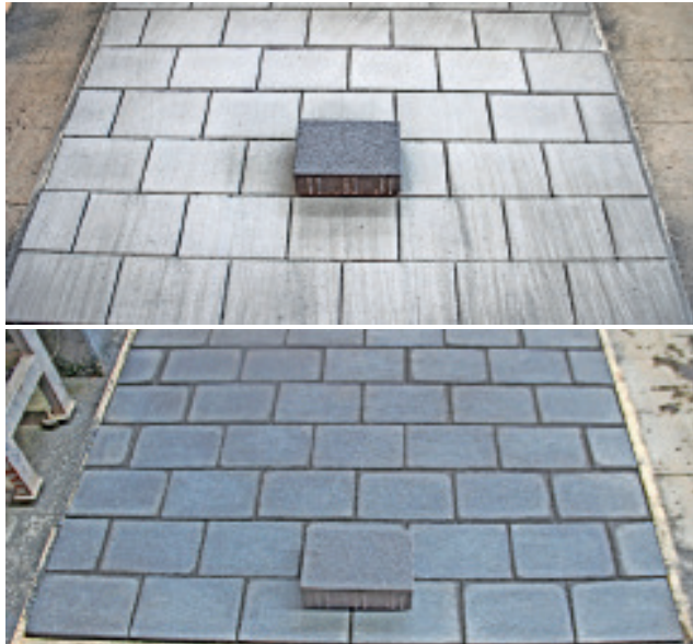
Abbildung 5: Oben: Verfärbung nach der trockenen Reinigung, unten: Verfärbung nach der nassen Reinigung.
