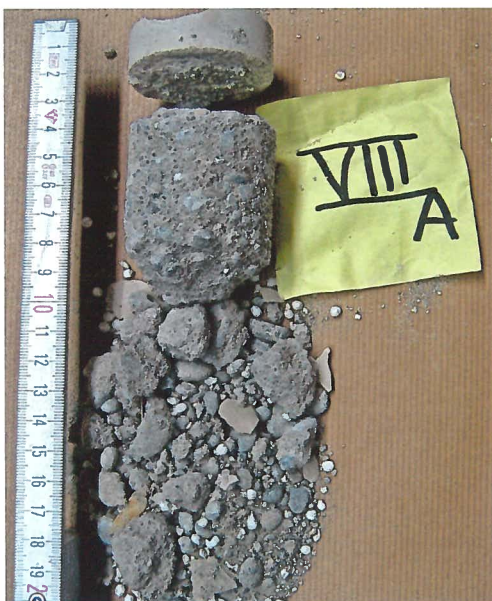
Bild 1: Verdichtungsprobleme an der Unterseite des Bettungsmörtels.
