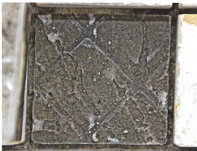
Bilder 17 a und b: Zahnung der Kontaktschlämme bei sachgerechter Verdichtung.
