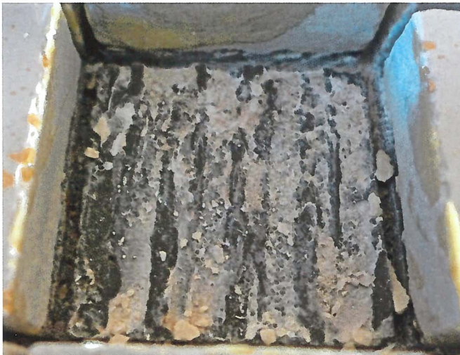
Bilder 16 a und b: Noch gut erhaltene Zahnung der Kontaktschlämme.
