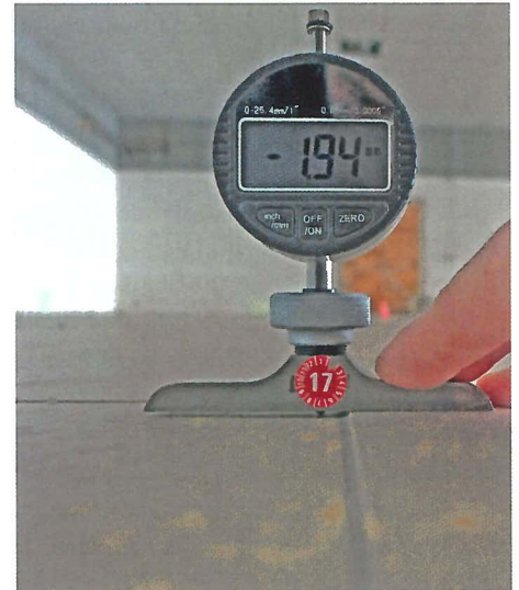
Bild 7: Resultierende Überzähne bei Einhaltung der halben Normwerte aber inkl. Verlegetoleranz.
