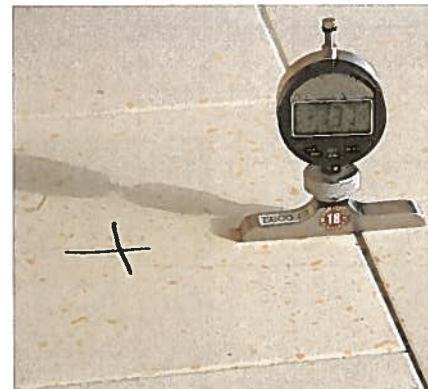
Abb. 5 a-c: Höhenversätze benachbarter Platten
