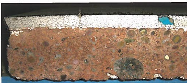
Abb. 10: Zementlinsen bei Verwendung werkgemischter Mörtel
