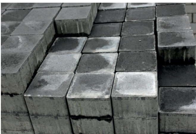
Abb. 5: Durch die Lagerung verursachte Sekundärausblühungen auf Betonpflastersteinen
