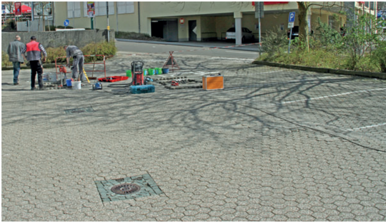
Abb. 8: Nicht ausreichend wasserdurchlässiger Unterbau
