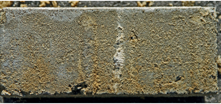
Abb. 9: Wasserspeicherung in der Fuge durch Verwendung feinstkörniger Sande
