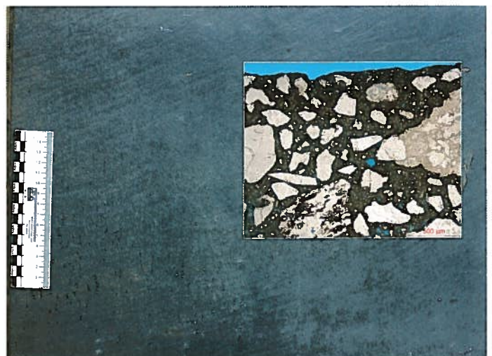
Imprägnierte Oberfläche: Ausbauprobe. Kleines Bild: Eindringfront – mikroskopische Querschnittsaufnahme.
