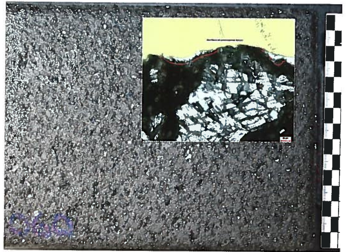
Dauerhafte teilgeschlossene schichtbildende Oberflächenvergütung – Produktionsmuster. Kleines Bild: Dauerhafte teilgeschlossene schichtbildende Oberflächenvergütung – mikroskopische Querschnittsaufnahme.
