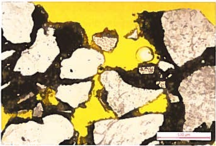
Lösender Angriff durch saures Reinigungsmittel – dauerhafte geschlossene schichtbildende Oberflächenvergütung.
