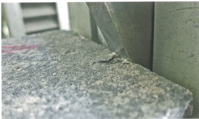
Abb. 16 a+b: Prüfverfahren zur Bewertung der Kantenstabilität von Pflastersteinen
