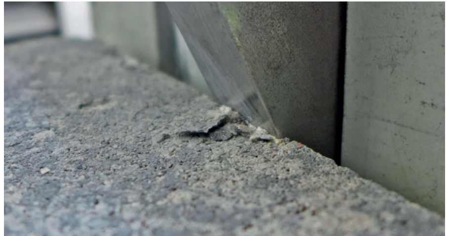
Abb. 16: Prüfverfahren zur Bewertung der Kantenstabilität von Pflastersteinen
