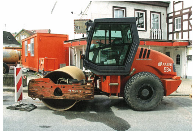
Bild 2: Nicht sachgerechte Nutzung einer Flächenbefestigung Fig. 2: Inappropriate use of concrete block pavement
