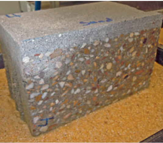
Bild 17: Saugfähigkeit des Kernbetons von Betonpflastersteinen bei rückwärtiger Durchfeuchtung
