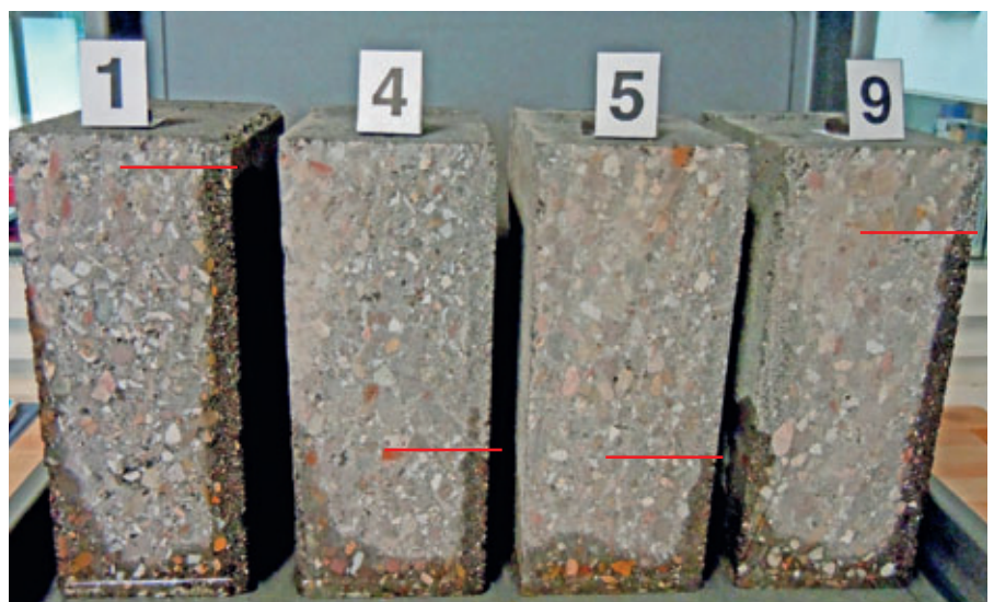
Bild 15: Saugverhalten des Vorsatzbetons (siehe rote Linien) von baustofftypischen Betonpflastersteinen (Steine 4 und 5) und von schlechten, baustoffuntypischen Betonpflastersteinen (Steine 1 und 9)
