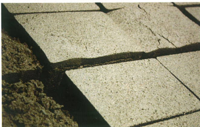
Bild 2: Fertigung von Pflastersteinen mit einem w/z-Wert von 0,43
