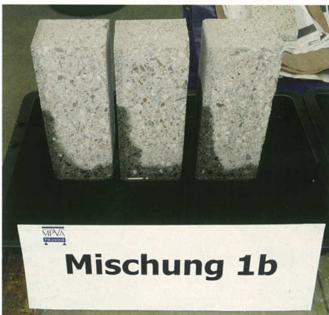
Bild 4: Saugverhalten der Pflastersteine der Mischungen 1b und 2b nach 90 min Prüfzeit
