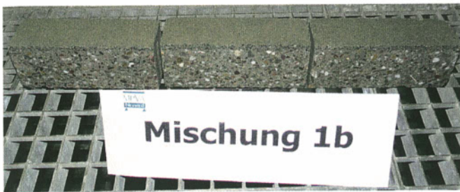
Bild 5: Abtrocknungsverhalten der Pflastersteine der Mischungen 1b und 2b nach 120 min Prüfzeit
