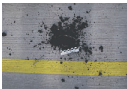
Abb. 15: Zwischenprodukt der Oxidation pyrithaltiger Gesteinskörnungen
