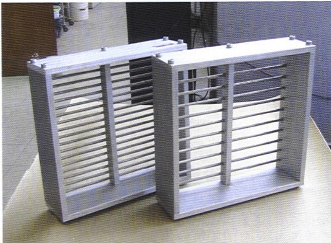
Abb 1: Stabsiebe für die Untersuchung der Plattigkeitskennzahl FI
