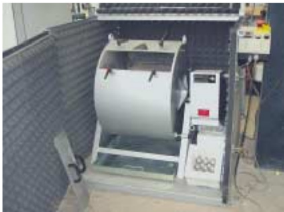
Bild 2. Prüfgerät zur Bestimmung des Los-Angeles-Koeffizienten Fig. 2. Apparatus used for determining the Los Angeles coefficient
