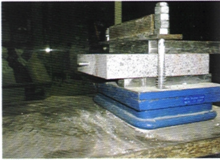
Bild 1: Einspannung der Prüfkörper.
