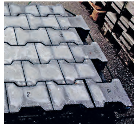
4. Aussinterungen auf Pflastersteinen.
