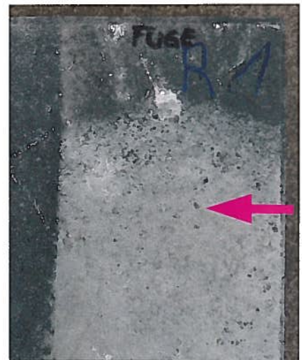
Abb. 8: Laborversuch zum Nachstellen der Verfärbung der Pflastersteine durch Einarbeiten des Fugenmaterials
