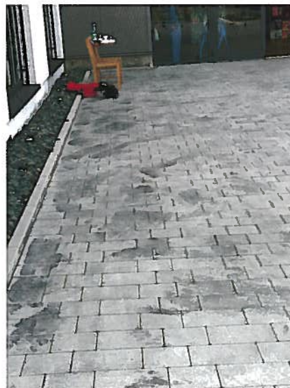
Abb. 8: Laborversuch zum Nachstellen der Verfärbung der Pflastersteine durch Einarbeiten des Fugenmaterials
