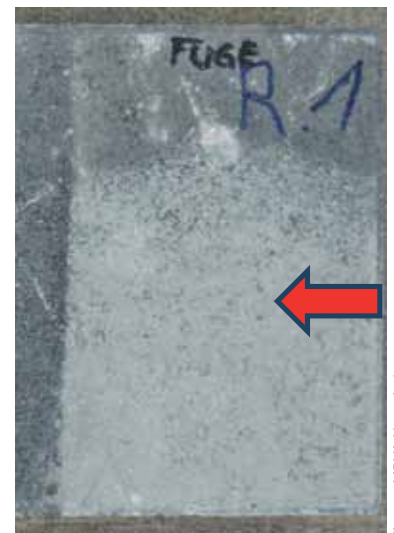
Schadensbeispiel 2: Laborversuch zum Nachstellen der Verfärbung der Pflastersteine durch Einarbeiten des Fugematerials
