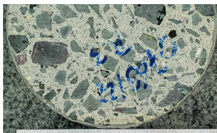
Abb. 27: Prüfkörper nach der Durchführung des CDF-Tests
