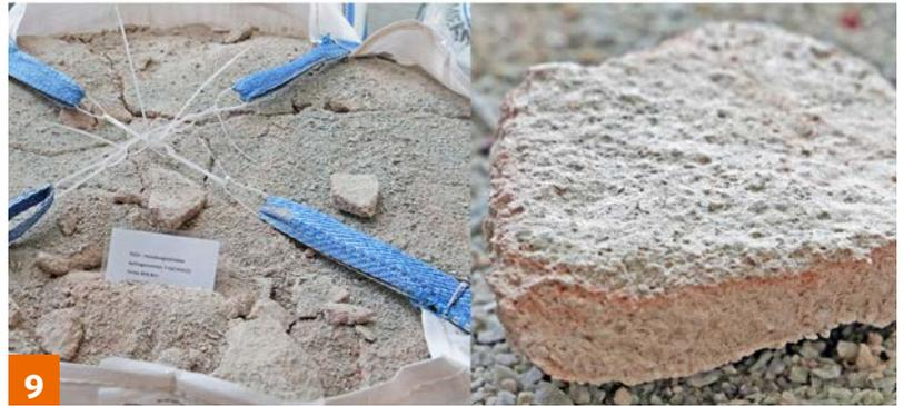
Bei der Anlieferung bereits teilweise verfestigtes Fugenmaterial.
