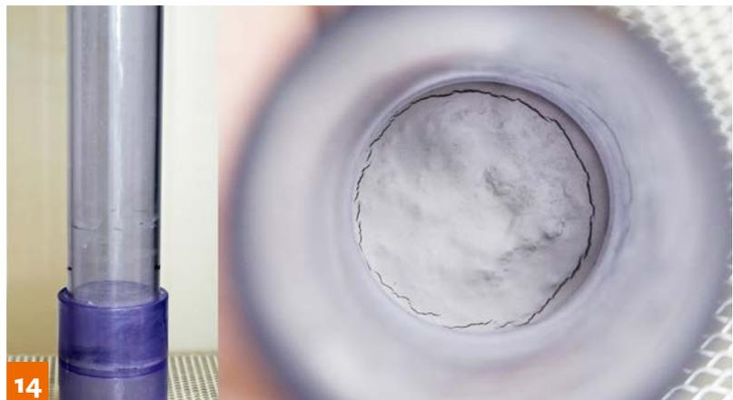
14 Prüfaufbau zum Nachweis der Verfestigungsneigung der Feinanteile.
