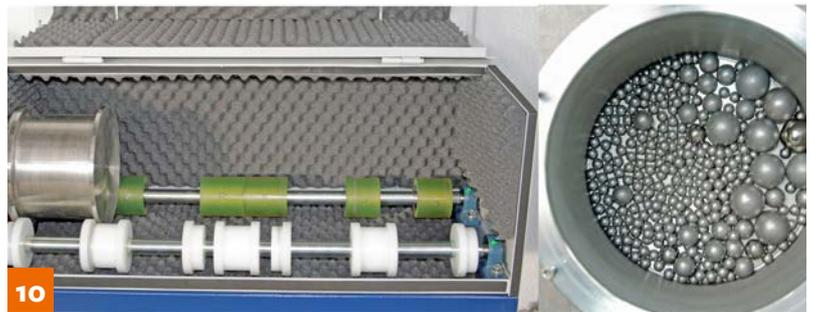
Verfahren zur Bestimmung der Kornfestigkeit mittels des modifizierten Micro-Deval-Verfahrens.
