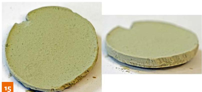
15 Im Prüfaufbau mit Wasser beaufschlagte Verfestigung der Feinanteile eines \*
