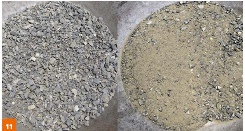
Verfeinerung eines Kalksteins im Rahmen der Durchführung des modifizierten Micro-Deval-Verfahrens (links vor dem Versuch und rechts nach dem Versuch).
