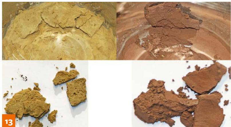
13 Verfestigungsneigung der Feinanteile eines Quarzes (links) und einer Lavaschlacke (rechts).
