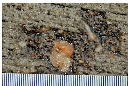
Abb. 6 a+b: Gesteinskörner mit dichtem Gefüge und einem hohen Frost-Tausalz-Widerstand im Zentrum von Zementsteinabwitterungen
