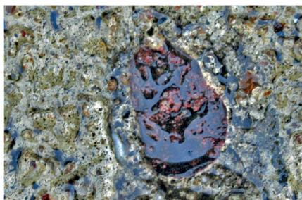
Abb. 5: Zersetzliches Gesteinskorn im Zentrum einer Zementsteinabwitterung
