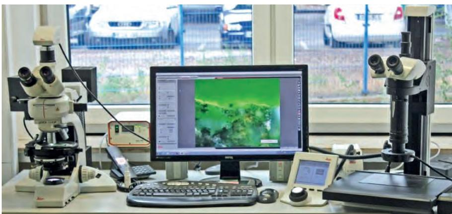
Bild 9: Bestimmung der Gehalte von Mikroluftporen an Betonen nach DIN EN 480-11
