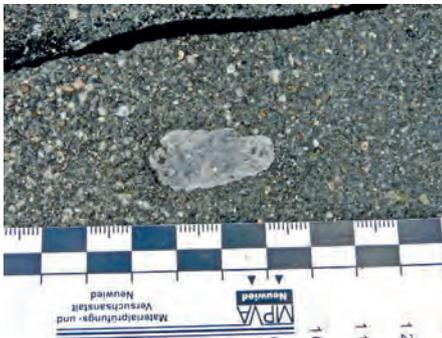
Bild 6: Gesteinskörner mit dichtem Gefüge und einem hohen Frost-Tausalz-Widerstand im Zentrum von Zementsteinabwitterungen
