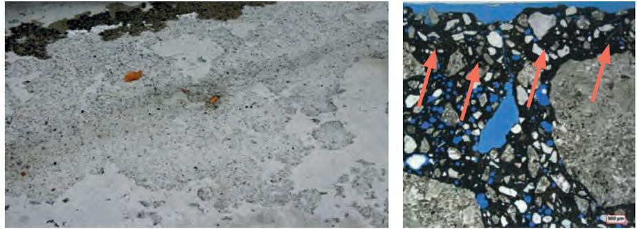
Bild 10: Reduzierte Menge an Mikroluftporen im Bereich der Betonoberfläche
